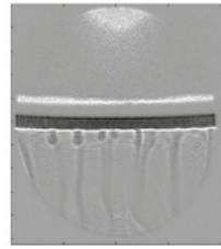
Dissolution du  $\text{CO}_2$  dans l'eau à  $p = 2 \text{ Mpa}$  visualisée par Shadowgraphie par le côté, configuration 2D
